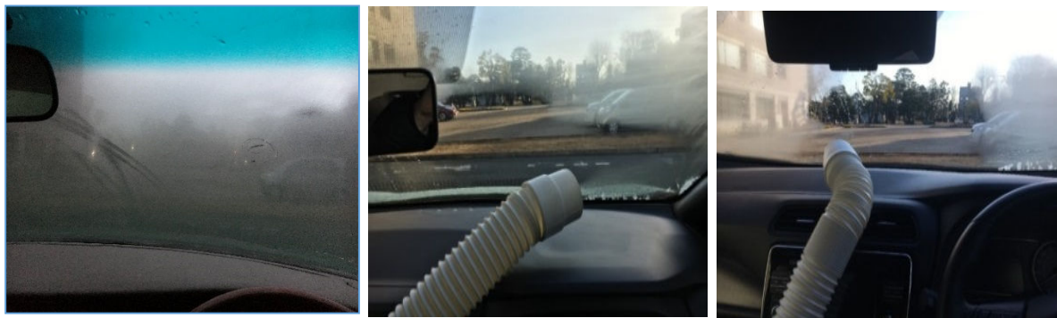
図11 リーフ窓ガラスの曇り 並びに 乾燥空気供給時の曇り除去の様子
